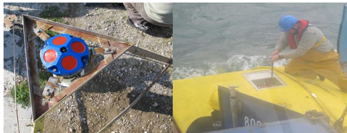
Figure 2. Supports des ADCPs (à gauche : tripode, à droite : blocs béton CREOCEAN)
