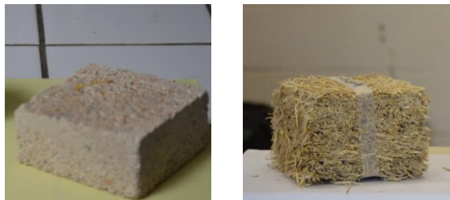
Figure 1. Mortier à base de sciure de bois (à gauche) et du béton paille (orge plâtre, à droite).
