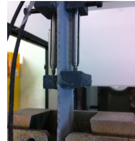
Figure 3. Traction directe de plaques de TRC
