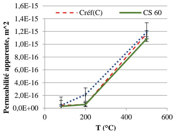
**Figure 5.** Evolution de la perméabilité intrinsèque résiduelle des bétons en fonction du cycle de chauffage - refroidissement
