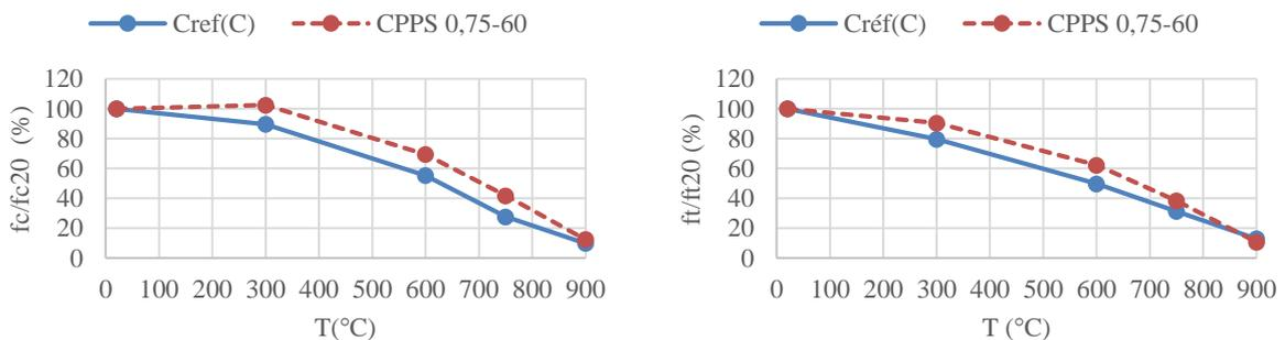
Figure 7. Evolution des résistances résiduelles relatives à la compression (a), et résistances résiduelles relatives à la traction (b) en fonction du cycle de chauffage - refroidissement
