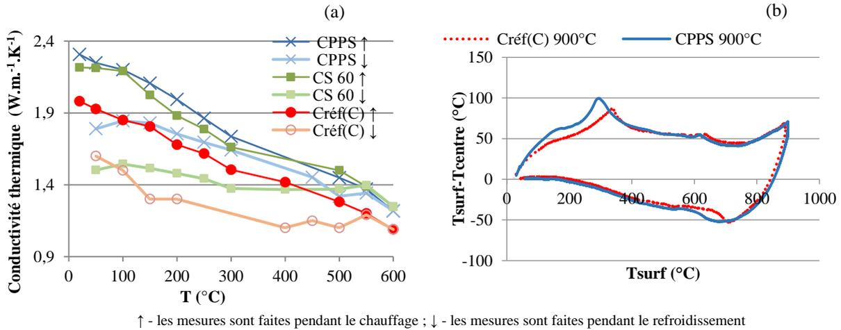
Figure 6. Évolution de la conductivité thermique (a) des bétons étudiés et différence des températures entre la surface et le centre d'éprouvette cylindrique (b), au cours de phase de chauffage et refroidissement
