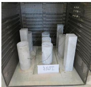
Figure 1. Disposition des éprouvettes dans le four
