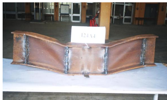
Figure 9. Mode de ruine pour le spécimen I24A4 avec 4 raidisseurs sur appuis.
